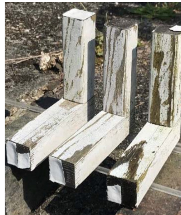
De geacetylerde L-verbindingen na 20 jaar blootstelling
