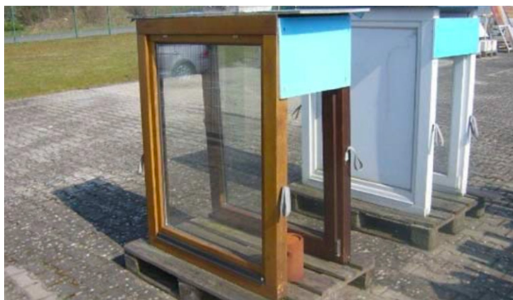
Testopstelling na 10 jaar blootstelling
