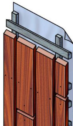
Tekening 4 Verticale open gevelbekleding op dubbel regelwerk.
